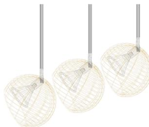
Las que se crean especialmente para las luces de exposición llevan una apertura inclinada hacia un lado para focalizar la luz y que cumplan así su función de "foco de exposición". Al diferencia de las anteriores la tulipa ya que tiene el hueco justo para pasar el cable, ya que la bombilla y el casquillo se introducen desde la apertura mayor de abajo.
